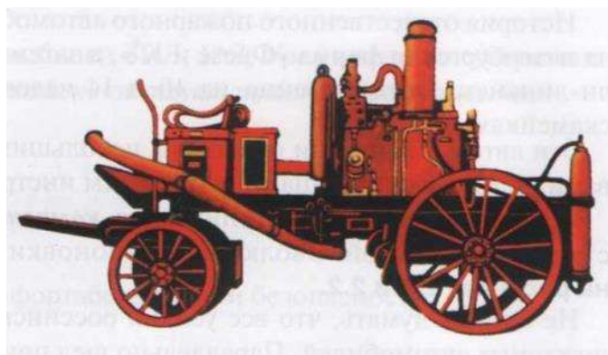
Паровой пожарный насос (1829 год)
